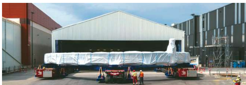
▲ La dernière bobine de champ poloidal fabriquée sur le site ITER par l'agence domestique européenne a été transportée vers un hangar de stockage.
