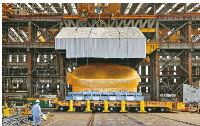
▲ La Corée du Sud a terminé la fabrication du quatrième secteur de la chambre à vide.
