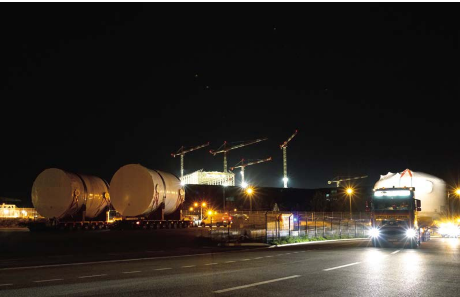
Arrivée sur le site d'ITER de trois réservoirs de stockage d'eau du circuit de refroidissement du tokamak, la nuit du 17 septembre 2015.
